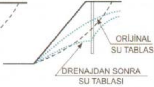
d) Drenaj ile su seviyesinin düşürülmesi
