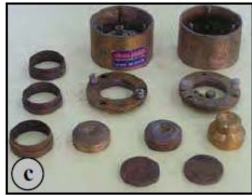
a) Ödometre cihazının genel görüntüsü, (b) konsolidasyon hücresi ve deformasyon saati, (c) hücre içi aparatlar, (d) numune ringleri (e) yükleme plakaları
