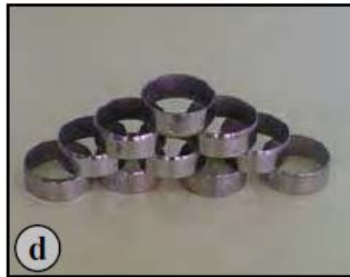
a) Ödometre cihazının genel görüntüsü, (b) konsolidasyon hücresi ve deformasyon saati, (c) hücre içi aparatlar, (d) numune ringleri (e) yükleme plakaları
